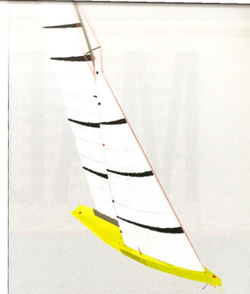
Ce logiciel permet d'obtenir une vue virtuelle du bateau et des voiles et de faire la jonction avec leur situation réelle en navigation. Sur cette représentation, on importe des éléments mesurés en situation réelle. Il est ainsi possible d'obtenir des simulations (on peut border, choquer, aplatisir ou creuser les voiles etc...) et les données qui leurs sont associées.
