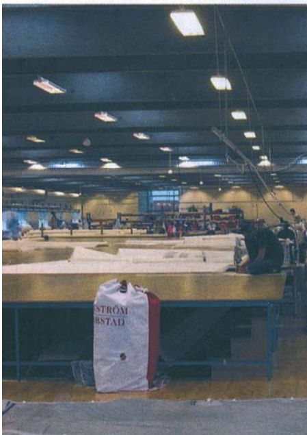
La zona del loft dove vengono tagliati e assemblati i pannelli per ottenere la forma tridimensionale della vela.
